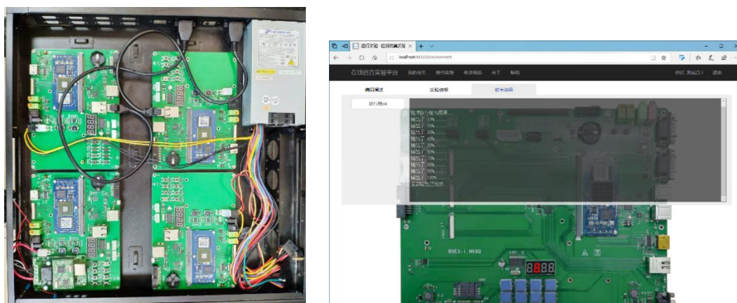
图 6 自研的 1U 嵌入式系统实验教学设备及用户界面
